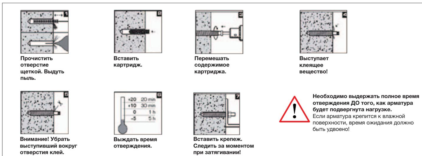
Рис. 8: Монтаж анкерных болтов на клеевой основе
