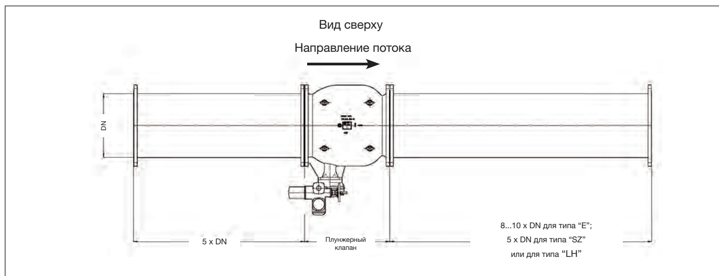
Рис. 3: Расположение клапана VAG RIKO®
