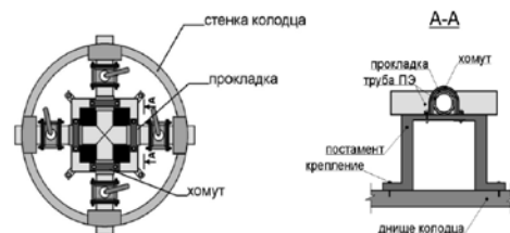
Рисунок 31 – Постамент для закрепления запорной арматуры
